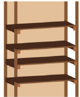
Cámara de secado (Zona donde se colocan los alimentos para ser deshidratados por el aire caliente que produce el colector).
