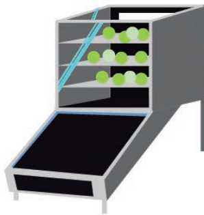
Colector (Sector donde la radiación calienta el aire que ingresa mediante efecto invernadero).
