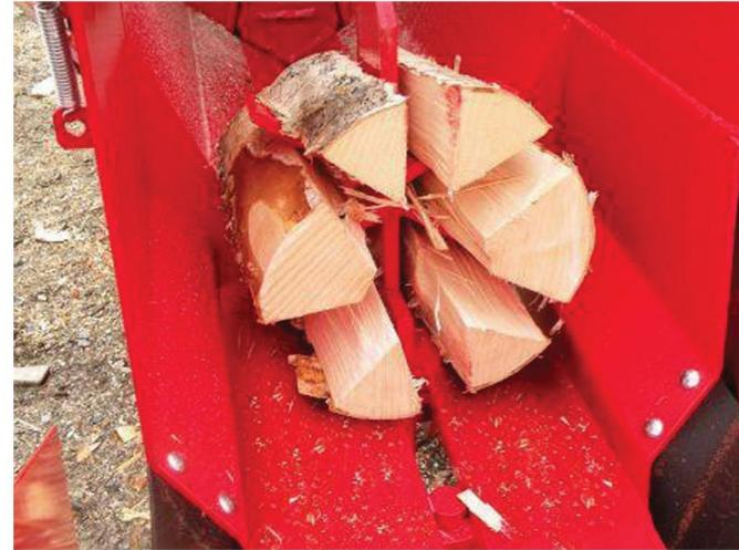
Cuchillas regulables e intercambiables que permiten obtener 4 ó 6 astillas
