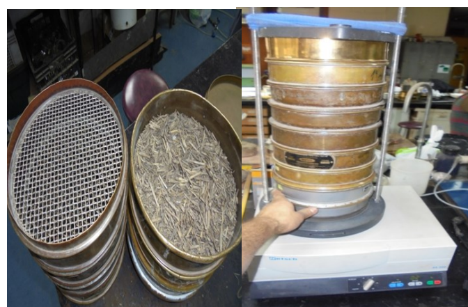
Tamices correspondiente a las medidas descritas en el texto, usados para determinar tamaño de partículas en rastrojo de trigo.
